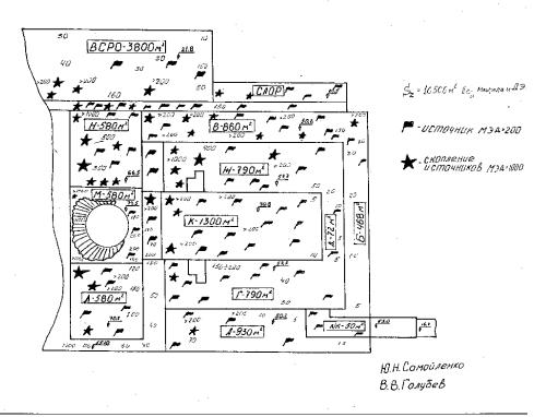
Флажком обозначены источники радиоактивности с МЭД более 200 р/час.
